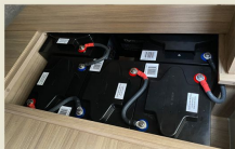
▲ A két hátsó kabin fekhelye alá került az elektromos hajtás akkumulátor-csomagja
